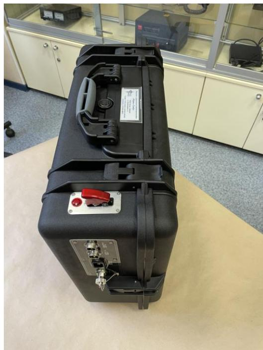
Комплекс имеет форм – фактор ударопрочного герметичного кейса с классом защиты IP68. Все разъемные соединения для удобства использования выведены на внешние стенки, и снабжены информационными табличками.
