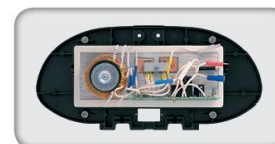
встроенный силовой блок
